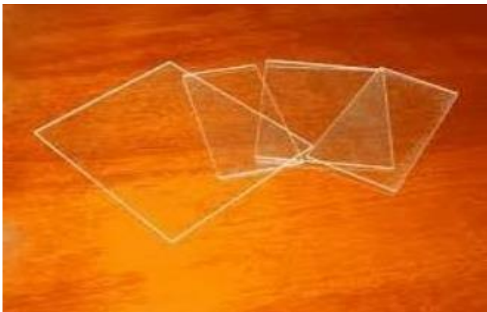
Slika 20. Čvrsti detektor nuklearnih tragova CR-39
