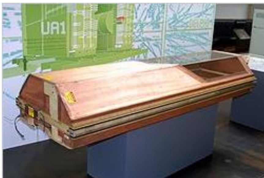
Slika 10. Povlačna komora- jedan oblik višeanodnog proporcionalnog brojača
