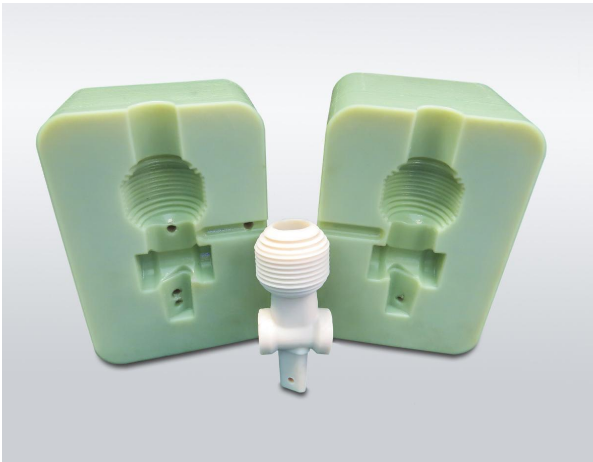
Slika 6. Primjer RT (Rapid Tooling) korištenja AM tehnologije
