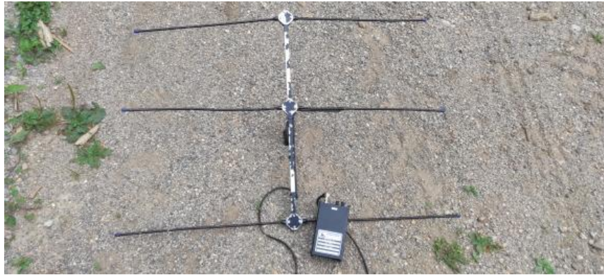
Slika br. 8 VHF prijemnik i antena za praćenje
