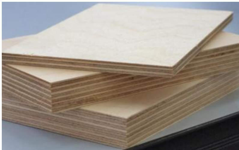
Slika 3. Slojeviti kompozit – šperploča [7]
