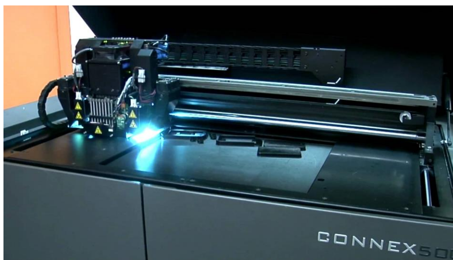
Slika 8. Polyjet pisac CONNEX 500 [8]
