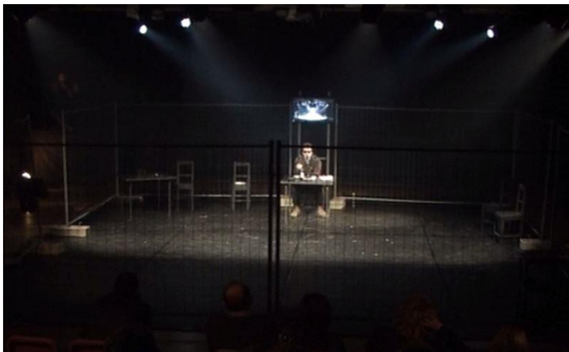
Slika br. 45: Osvijetljene zone 4, 5 i 6. Zone 4 i 5 osvijetljene su prednjim svjetlom, dok je zona 6 osvijetljena bočnim svjetlom. U slici rade i kontre postavljene dijagonalno u odnosu na sredinu pozornice
