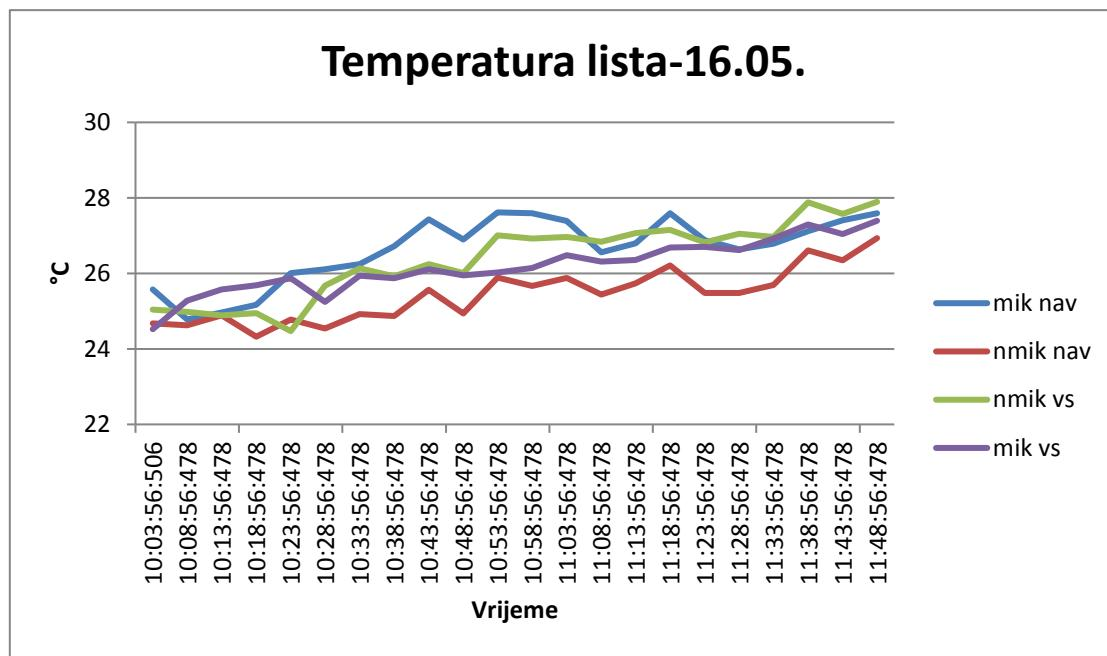
Grafikon 7. Temperatura lista izmjerena pomoću termoparova 1. dan snimanja
