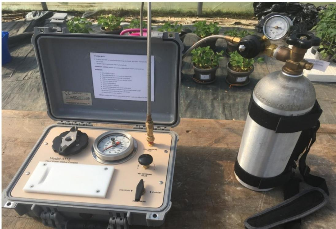
Slika 5. Instrument za mjerjenje vodnog potencijala lista
