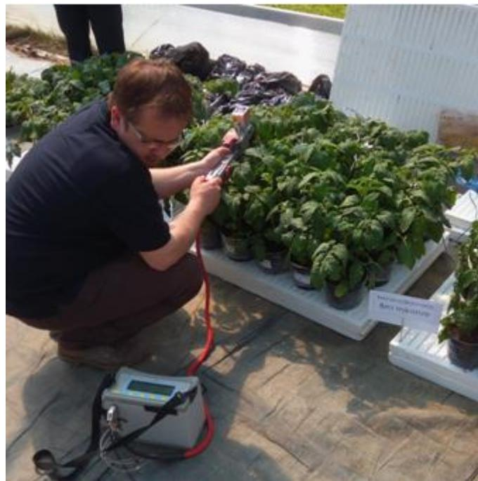
Slika 6. Mjerenje fotosinteze
