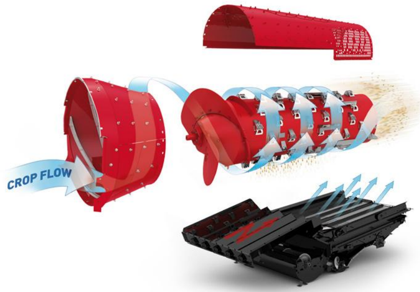
Slika 3.10. Aksijalni vršidbeni aparat sa jednim rotorom
