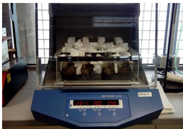
Slika 8. Uravnoteženje otopine tla u termostatirajućoj horizontalnoj tresilici
