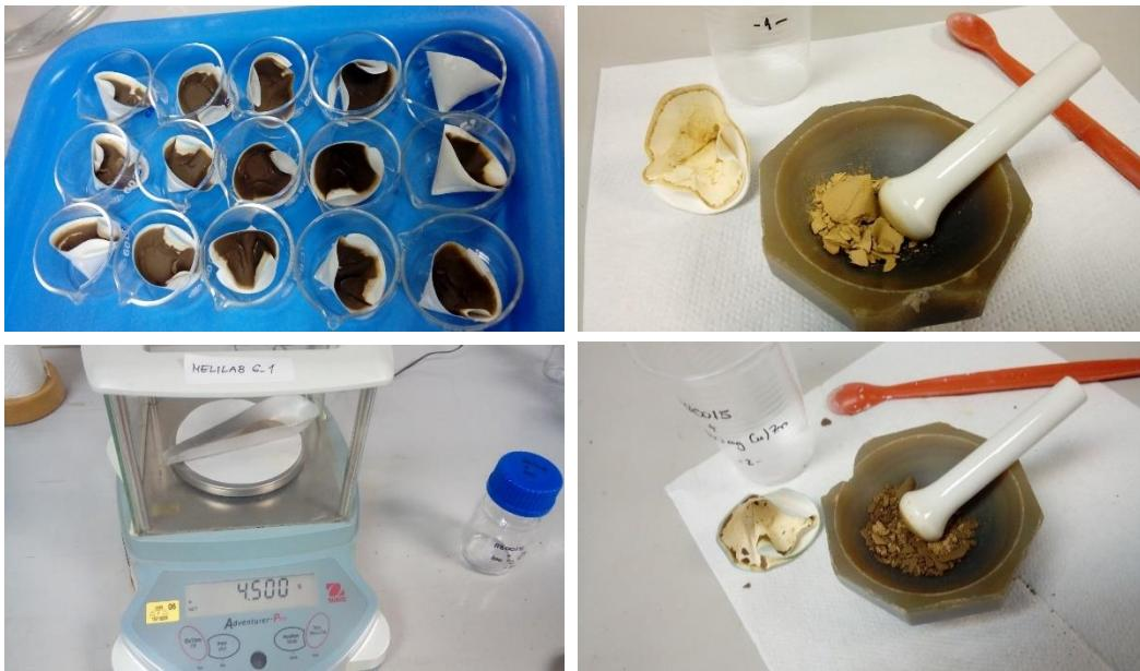
Slika 10. Pripremljeni uzorci za provođenje desorpcijskih pokusa
