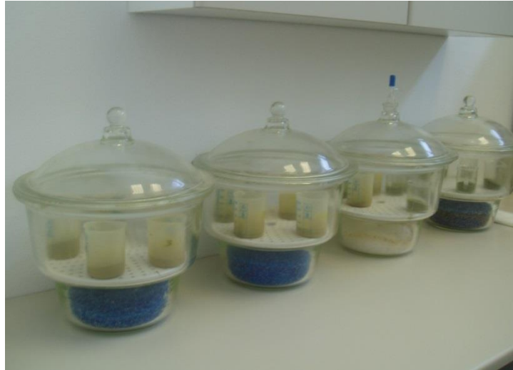
Slika 3.5.2. Hlađenje uzoraka sjenaže u eksikatorima prije skeniranja na NIR aparatu (izvor: Marina Vranić)
