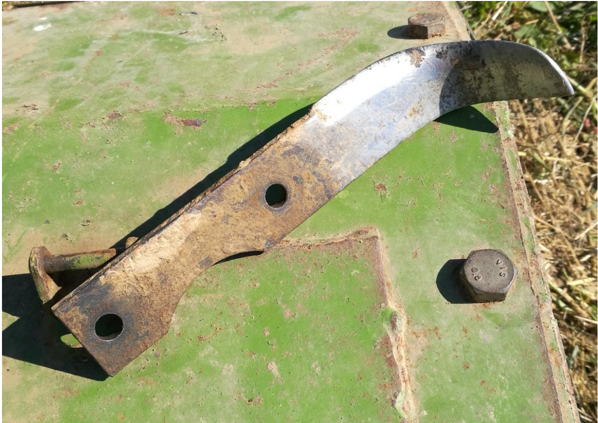
Slika 5.12. Standardni čelični nož debljine 5 mm
