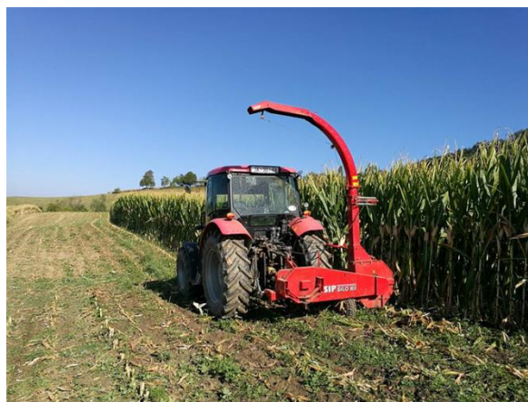
Slika 2. Košnja i usitnjavanje biljne mase – silo-kombajn
