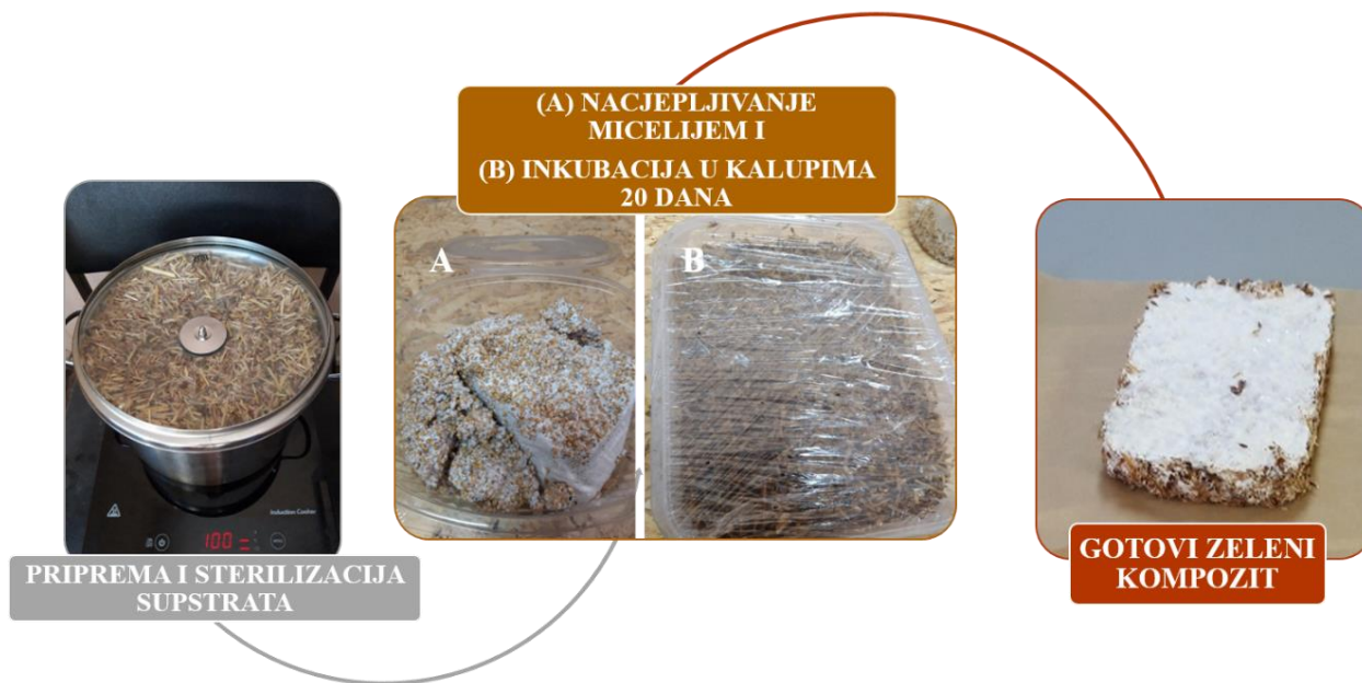
Slika 7. Shematski prikaz postavljanja eksperimenta
