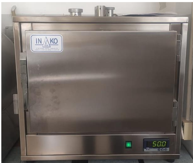
Slika 3.3. Laboratorijski sušionik „INKO” ST 40
