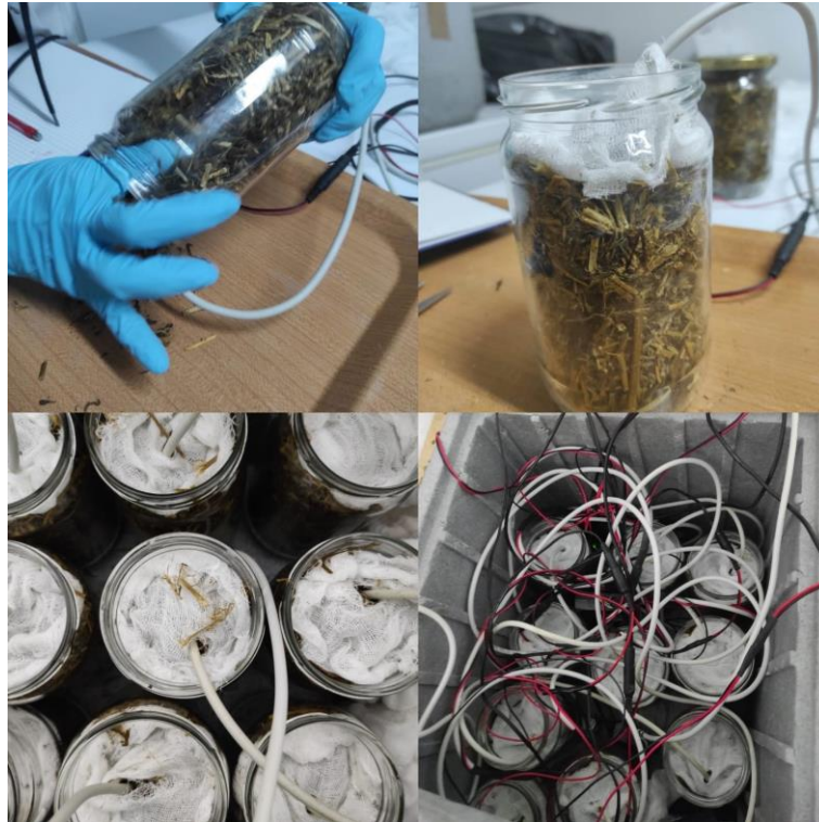
Slika 3.2.1. Uzorci u staklenim posudama s temperaturnim sondama prekriveni medicinskom gazom
