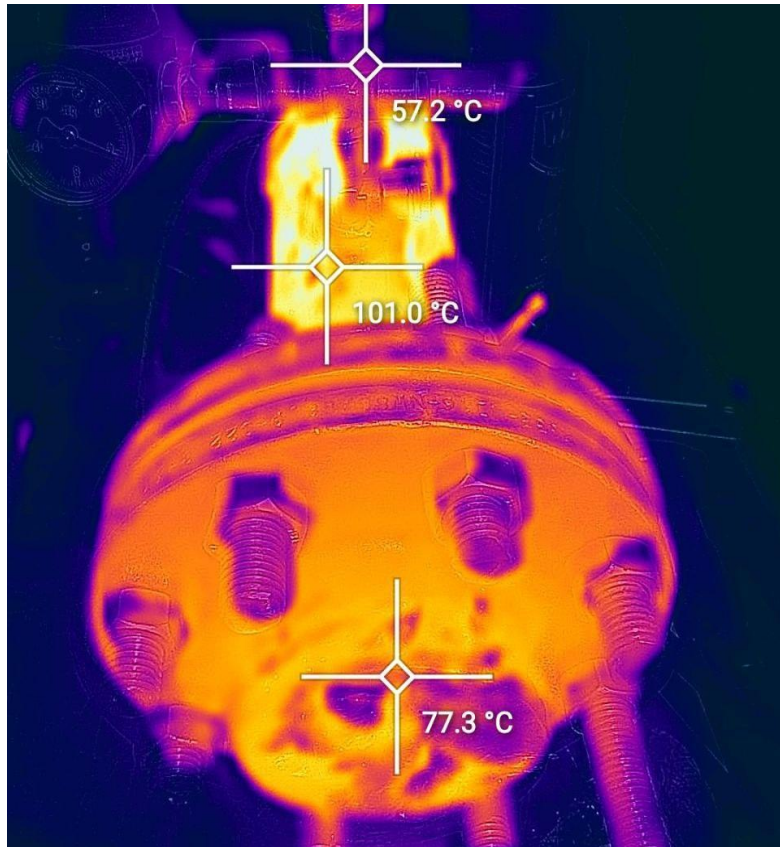
Slika 11.2. Termalna fotografija komore tijekom njezina rada
