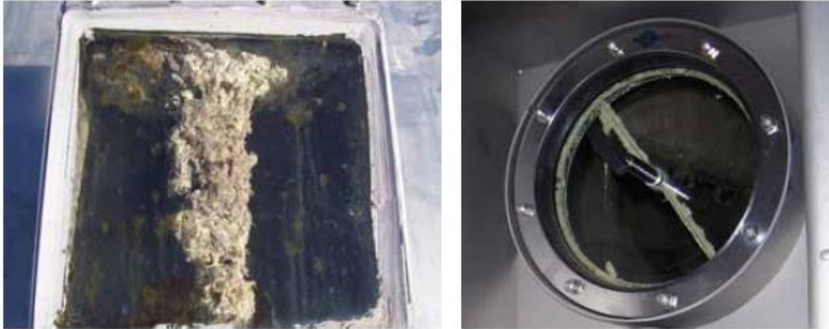
Slika 6. Elementarni sumpor, rezultat biološke desumporizacije
