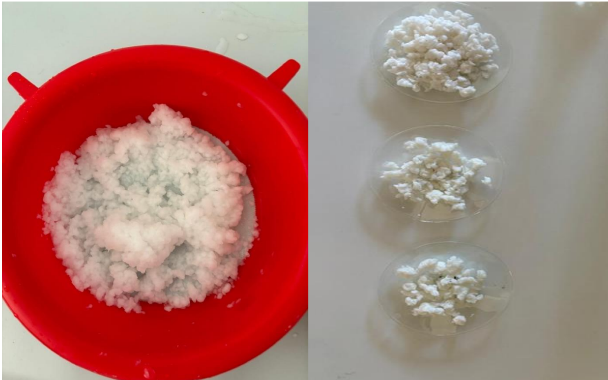
Slika 13. Filtracija defibriranih vlakana i sušenje
