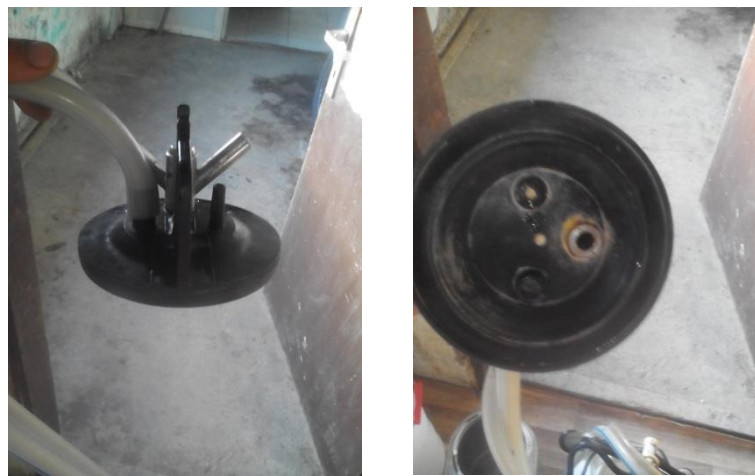
Slika 5. Pulzator – srce muznog uređaja (Foto: Švub)
