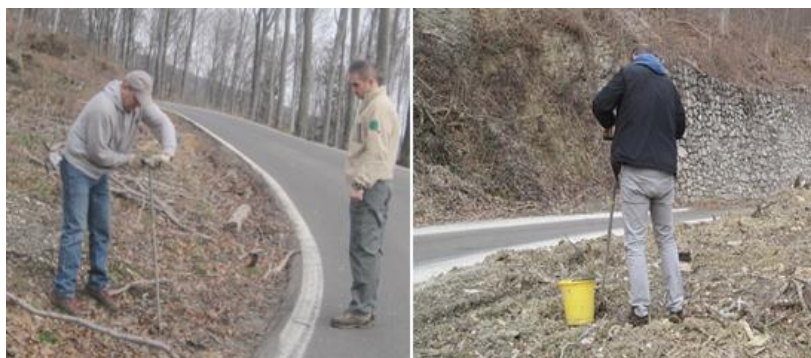
Slika 8. Uzorkovanje tla uz cestu (Izvor: Bulić, 2015).
