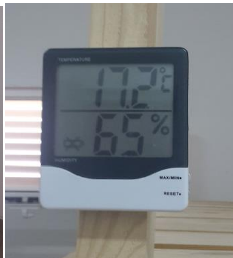
Slika 3.6. Vlagomjer za mjerenje relativne vlažnosti zraka (Izvor: fotografija, D. Petrović)
