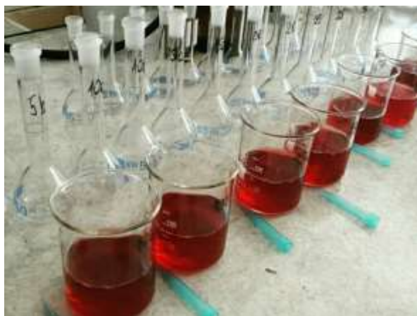
Slika 3. Priprema vodenih uzoraka za određivanje sadržaja osnovnog kemijskog sastava (Fotografija: Daniela Patricia Bilić, 2016)
