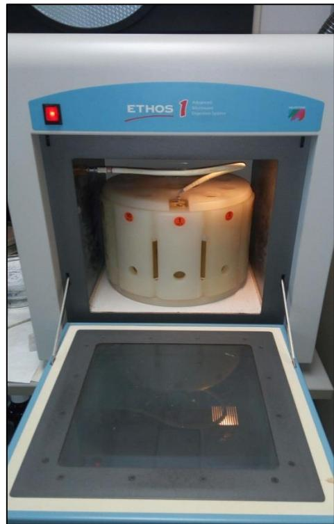
Slika 3.2.7. Mokro spaljivanje uzoraka u mikrovalnoj peći
