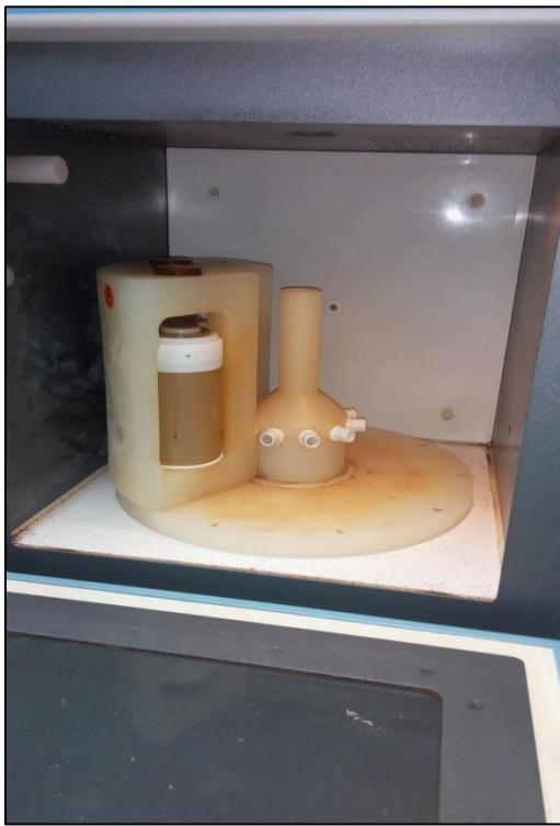
Slika 3.2.6. Slaganje uzoraka tretiranih smjesom kiselina u mikrovalnu peć
