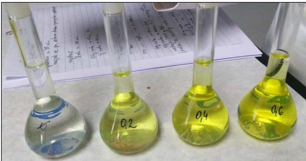
Slika 3.2.8. Radni standardi korišteni pri kalibraciji spektrofotometra
