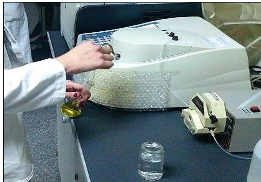
Slika 3.2.9. Očitavanje količine analita u otopini na spektrofotometru
