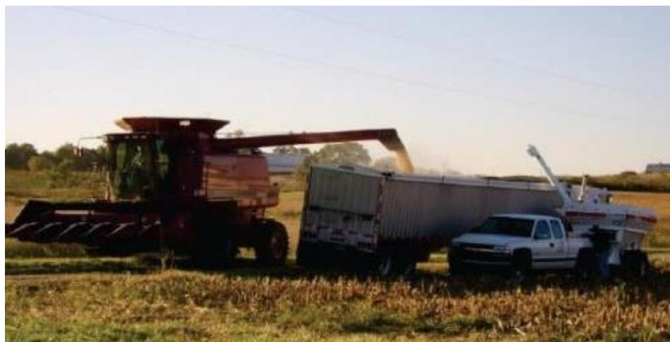
Slika 7.1. Prikolica opremljena vagom za mjerenu mase zrna u postupku umjeravanja senzora za mjerenu uroda
