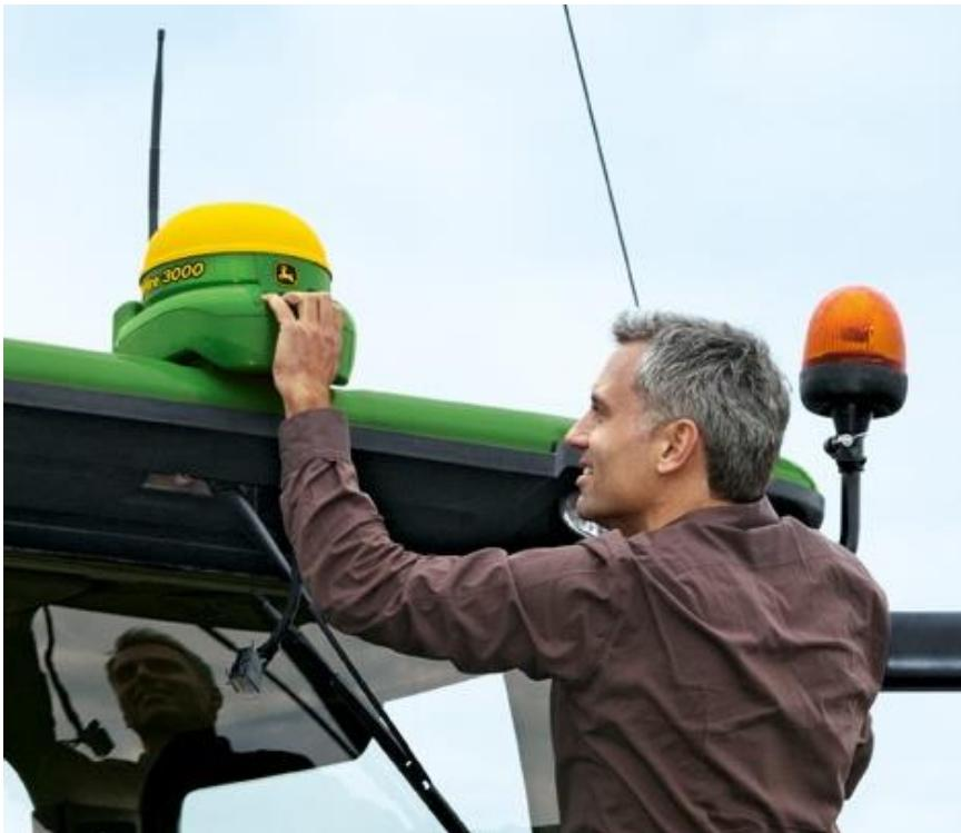
Slika 6.13. GPS antena i njezina instalacija na kombajn (John Deere)
