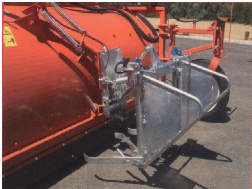
Slika 6.19. Ticala senzora za vođenje uređaja za pripremu i vađenje šećerne repe
