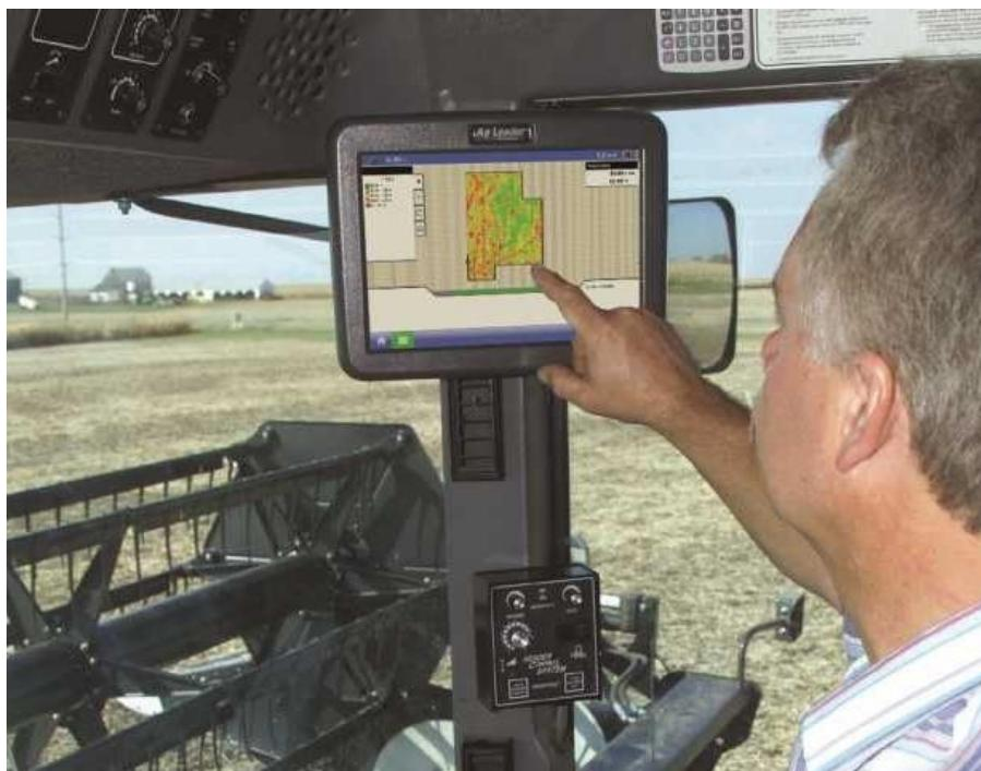
Slika 6.12.. Korisničko sučelje modernog sustava za mjerjenje uroda smješteno u kabini kombajna (sastoji se od sjedinjenog zaslona osjetljivog na dodir i računala) (AgLeader)
