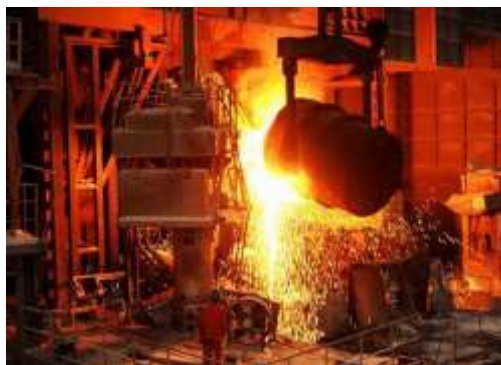
Slika 2.1. Proces proizvodnje elektropećne troske
