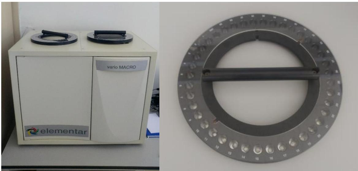
Slika 12 : CHNS analizator s autosamplerom (Izvor : vlastita arhiva)
