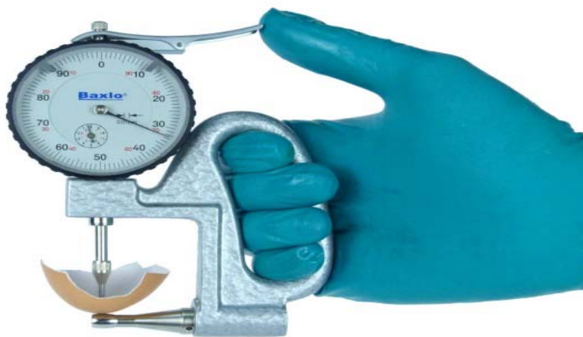
Slika 2.12.3. Mjerač debljine ljuske
