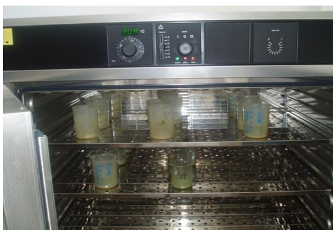
Slika 3.5.1. Uzorci sjenaže stavljeni na dosušivanje u sušionik (izvor: Marina Vranić)
