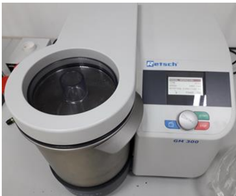
Slika 2. Laboratorijski mlin korišten za usitnjavanje rezidbenih ostataka
