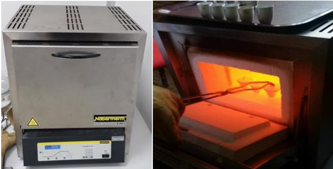
Slika 5. i 6. Mufolna peć za određivanje sadržaja pepela i koksa
