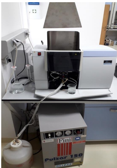
Slika 9. Atomski apsorpcijski spektrometar
