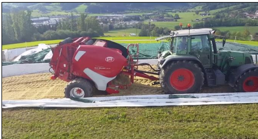
Slika 4.1. Lely Welger RP 160 V rotacijska preša
