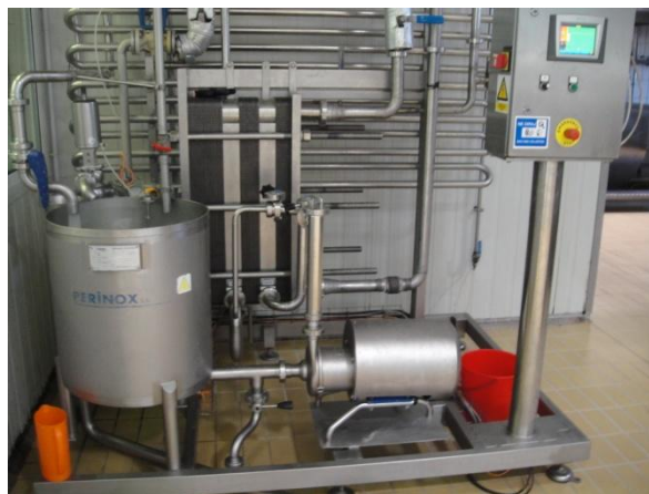
Slika 4. Prikaz pločastog pasterizatora (Izvor: Vlastita fotografija)
