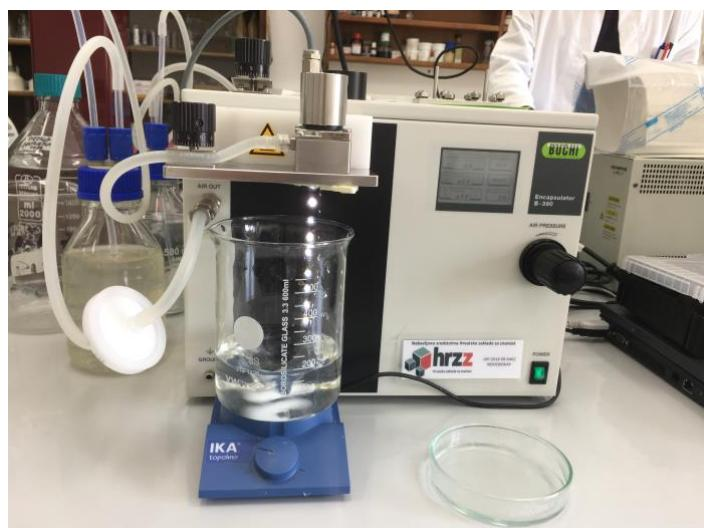
Slika 2.2.1. Izrada mikrokapsula u Encapsulatoru B – 390
