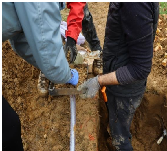
Slika3.2.3. Postavljanje tlačnog lizimetra
