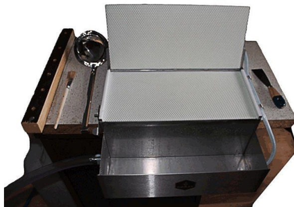
Slika 5. Preša za izradu satnih osnova
