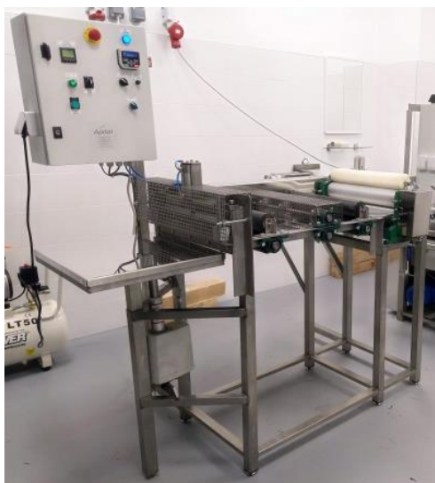
Slika 6. Valjak za izradu satnih osnova
