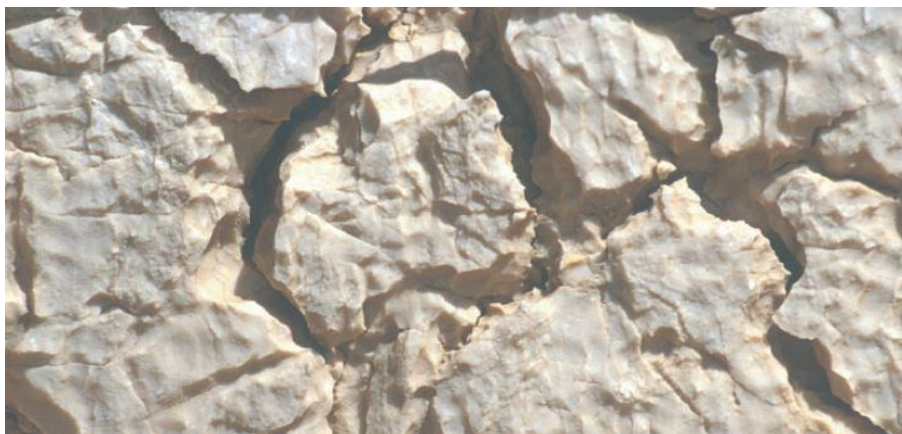
Slika 2.2.13. Oblik nastao gubitkom materijala - mikrokrš izvor: Fitzner i Heinrichs, 2004.
