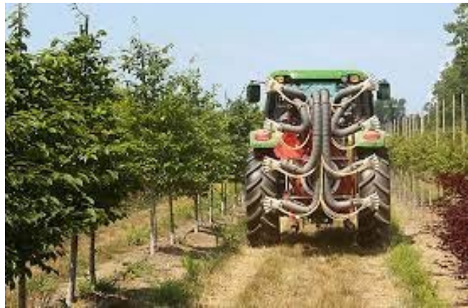
Slika 8.7. Orošivač sa osjetnicima za lasersko navođenje mlaza Izvor: (Pozder, Krušelj, 2018.)
