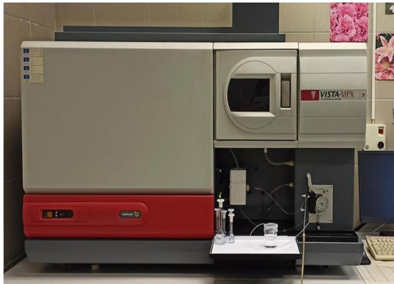
Slika 3.3.2.3. Optički emisijski spektrometar induktivno spregnutom plazmom (Vista MPX AX, Varian).
