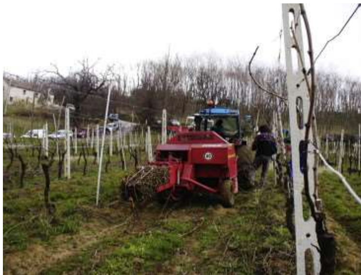
Slika 5. Prikupljanje i prešanje orezanih ostataka u vinogradu (Spinelli i sur., 2009.)
