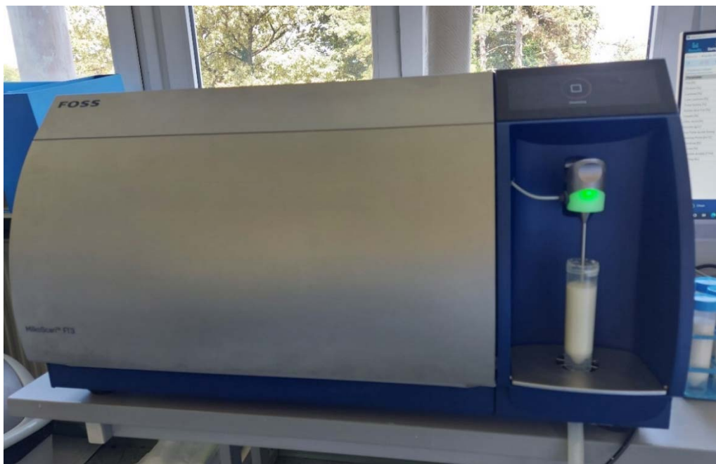
Slika 1. Milkoscan FT3 (Izvor: Foss Electric, Danska)
