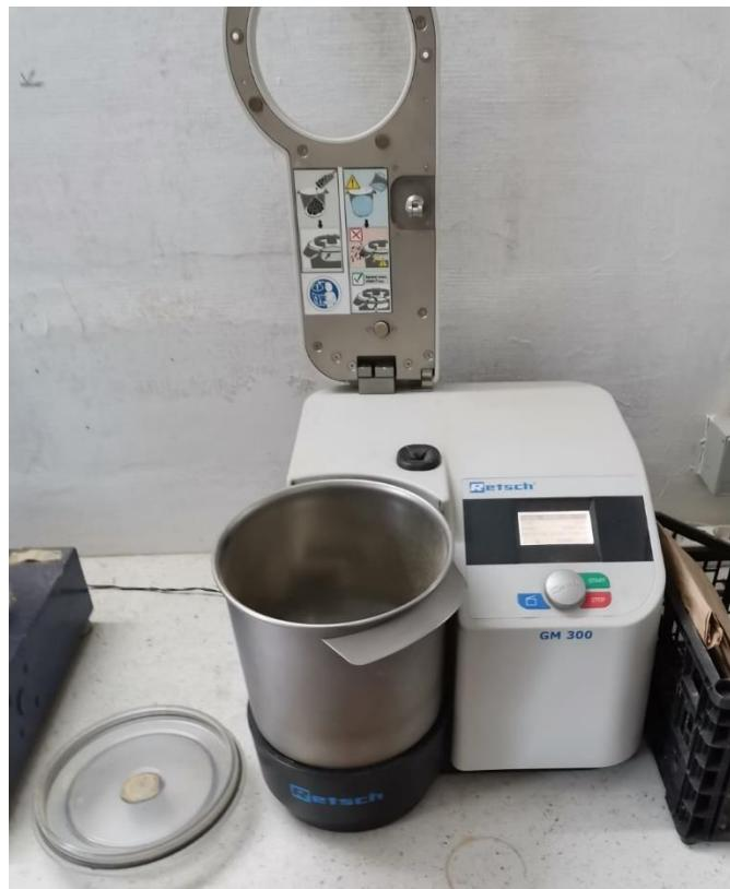
Slika 3.2.7. Laboratorijski mlin Retsch GM 300
