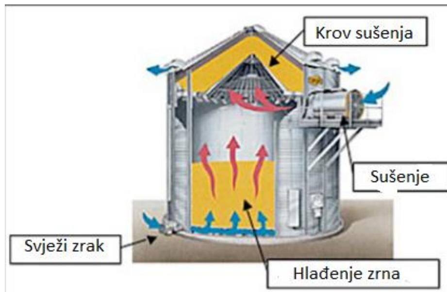
Slika 7. Sušenje u krovu silosa
