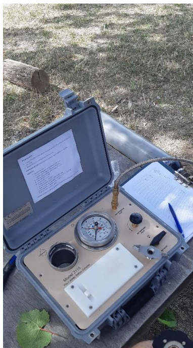
Slika 3.5. Uređaj za određivanje vodnog potencijala vinove loze (Foto: Ivan Magdić)
