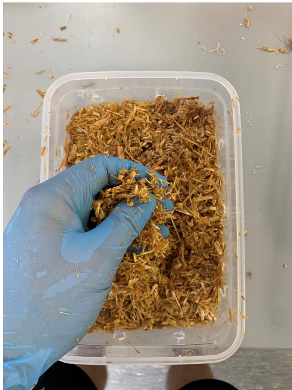
Slika 11. Prikaz homogenizacije supstrata
