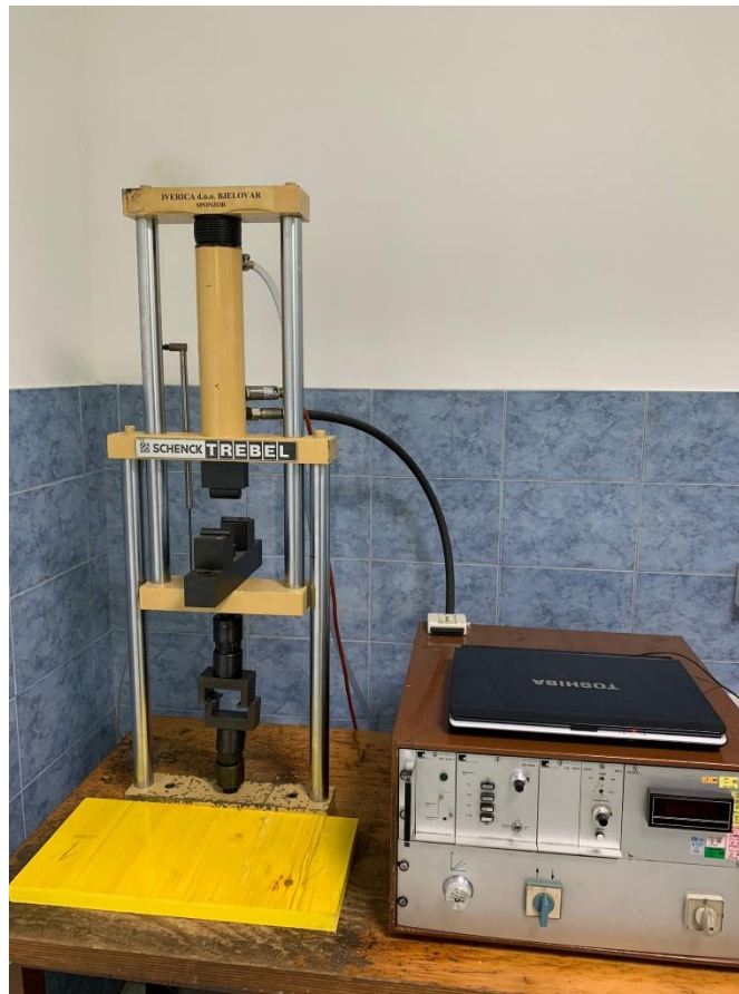
Slika 26. Kidalica za provođenje testa savojne čvrstoće
