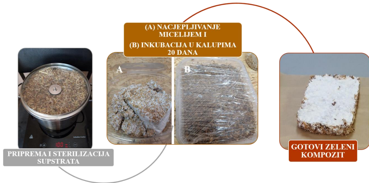
Slika 7. Shematski prikaz postavljanja eksperimenta
