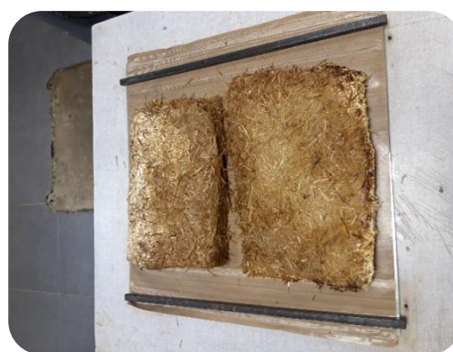
Slika 16. Shematski prikaz prešanja uzoraka
