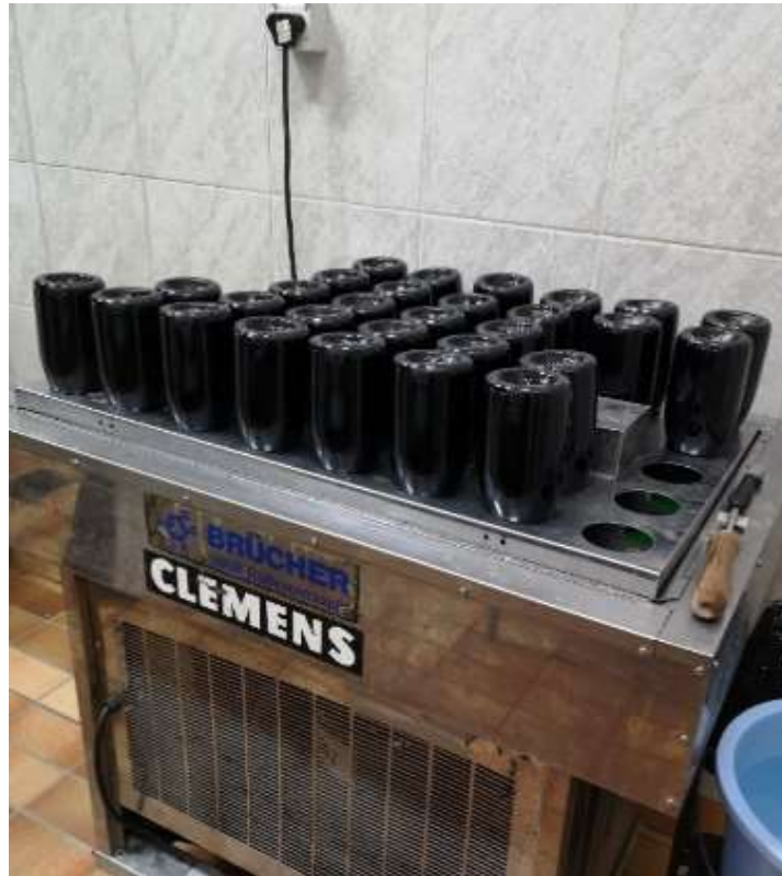
Slika 2.7. Smrzavanje taloga u bocama Izvor: Šikač I.
