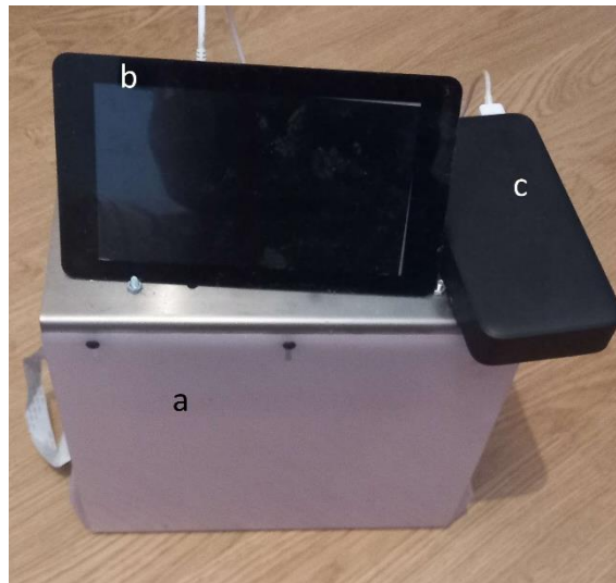
Slika 3.1.2. Prikaz uređaja za uzimanje slikovnih podataka (a – kućište, b – računalo, c – baterija)
