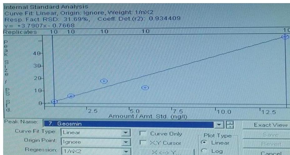
Slika 22. Kalibracijska krivulja geosmina
