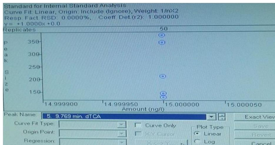
Slika 24. Kalibracijska krivulja internog standarda d TCA
