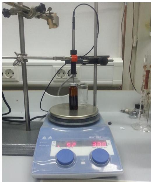
Slika 18. Priprema uzorka za analizu na magnetnoj miješalici
