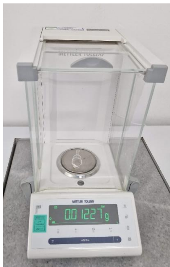
Slika 3.3. Prikaz odvage na analitičkoj vagi MS105DU, Mettler Toledo, Greifensee, Švicarska Izvor: Veronika Nikolaš
