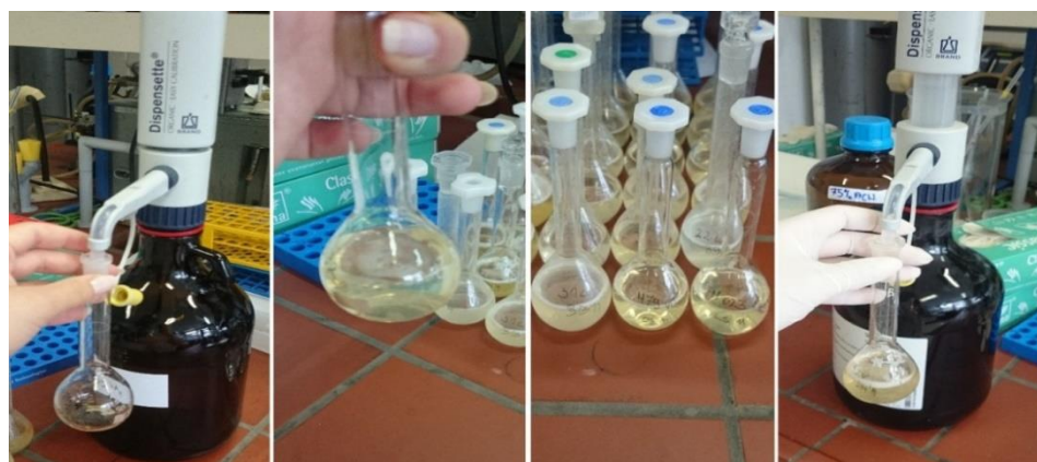
Slika 5: Dodavanja destilirane vode, laganog miješanja tikvice, otapanja meda i dodavanja acetonitrila (Izvor: Barkijević, 2016)
