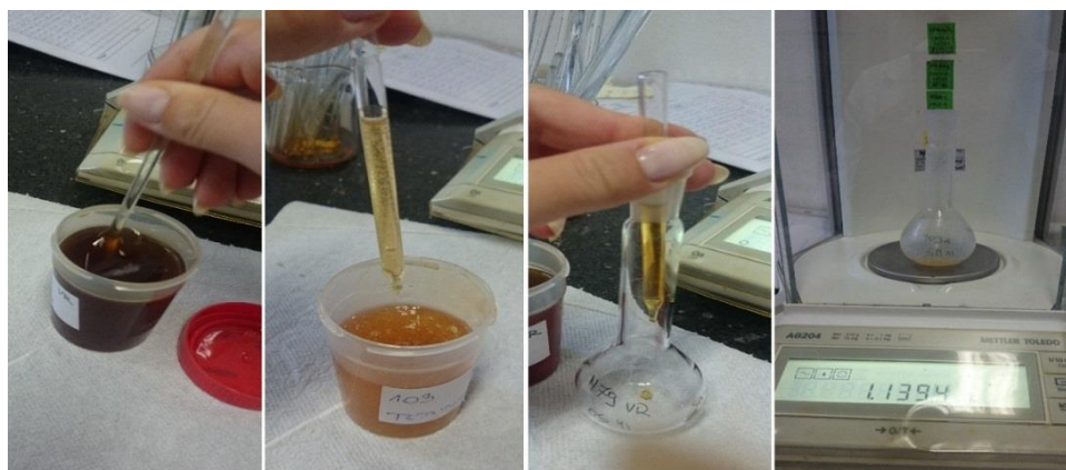
Slika 4: Prikaz homogenizacije, pipetiranja i vaganja uzorka meda
