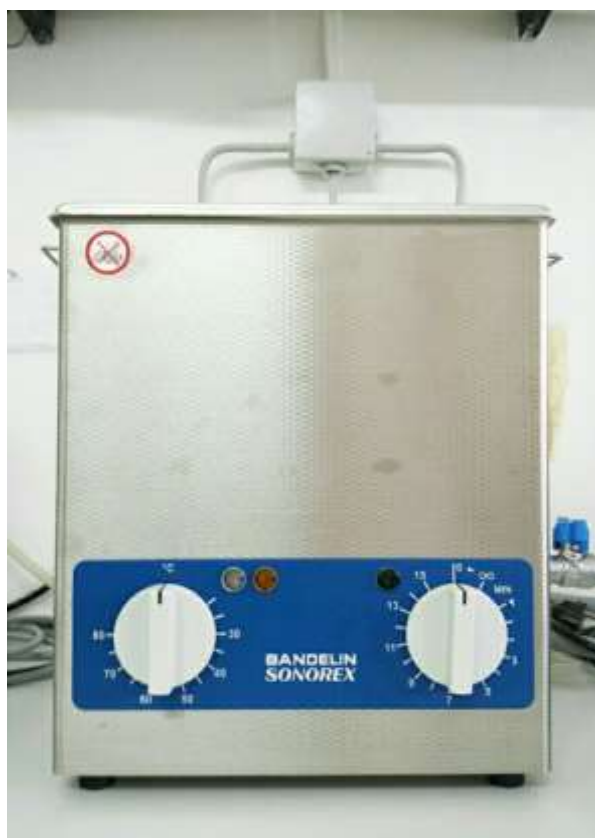
Slika 4. Ultrazvučna kupelj „Bandelin” RK 103H (Fotografija: Daniela Patricia Bilić, 2016)
