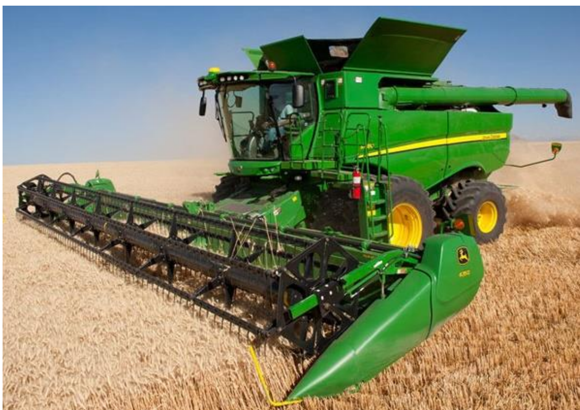
Slika 3.1. Suvremeni samokretni univerzalni žitni kombajn s žetvenim uređajem za strne žitarice (John Deere)
