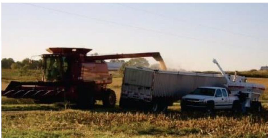
Slika 7.1. Prikolica opremljena vagom za mjerenje mase zrna u postupku umjeravanja senzora za mjerenje uroda
